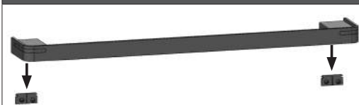
Clipser le produit sur sa platine de fixation Snap the product on its wall plate
