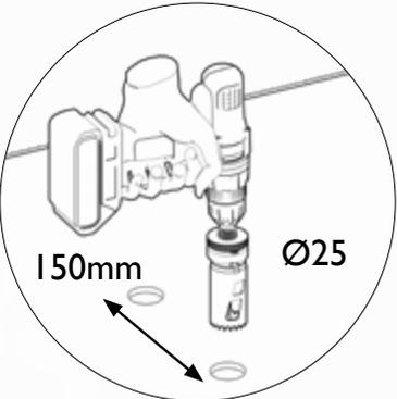
2- Percer le coffre avec une scie cloche
