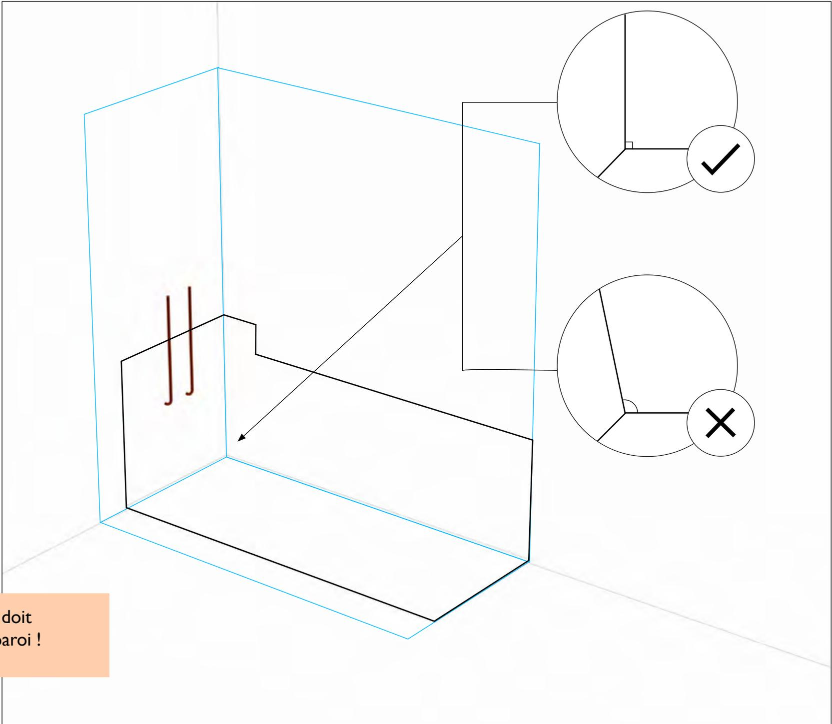
Attention : la tuyauterie ne doit pas traverser le profilé de paroi !
