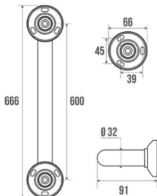
Tube laiton nickelé chromé Ø 32 mm.
