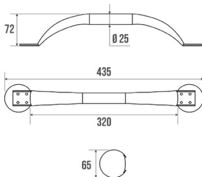
Tube inox 304 Ø 25 mm. Monopoutre.
