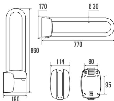
Tube aluminium blanc Ø 30 mm. Platines en résine de synthèse.
