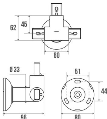
Polyamide injecté (nylon) blanc. Tube Ø 33 mm.
