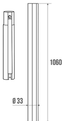
Multicomposants : résine de synthèse blanc + profil aluminium. Tube Ø 33 mm.
