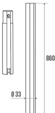
Multicomposants : résine de synthèse blanc + profil aluminium. Tube Ø 33 mm.
