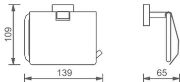
Distributeur papier WC avec couvercle CUBIC L139 x P65 x H109 mm, en laiton chromé, fixations invisibles et visserie fournie.
