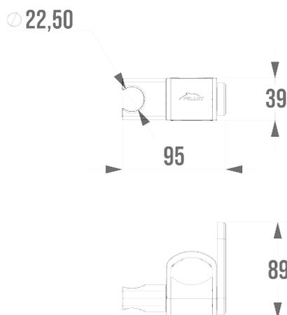
À monter sur les barres ErgoLife en nylon.
