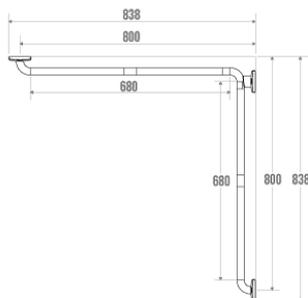
Multicomposants : Nylon + profil acier. Tube elliptique 38 x 25 mm pour une meilleure préhension.
