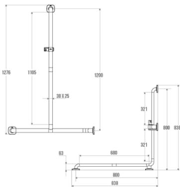
Multicomposants : Nylon + profil acier. Tube elliptique 38 x 25 mm pour une meilleure préhension.
