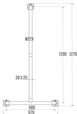
Multicomposants : Nylon + profil acier. Tube elliptique 38 x 25 mm pour une meilleure préhension.
