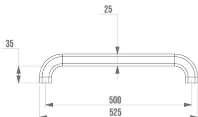
Multicomposants : Nylon + profil acier. Tube elliptique 38 x 25 mm pour une meilleure préhension.
