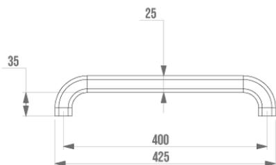
Multicomposants : Nylon + profil acier. Tube elliptique 38 x 25 mm pour une meilleure préhension.
