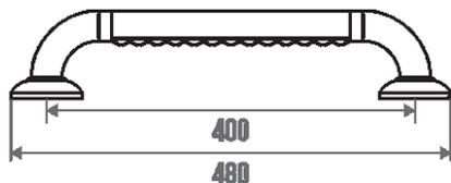
Multi composants: polyamide injecté blanc (Nylon) + profil aluminium époxy gris, type RAL 7012.
