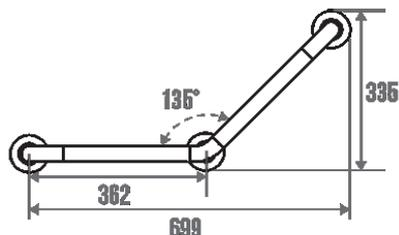
Multi composants: polyamide injecté blanc (Nylon) + profil aluminium époxy gris, type RAL 7012.
