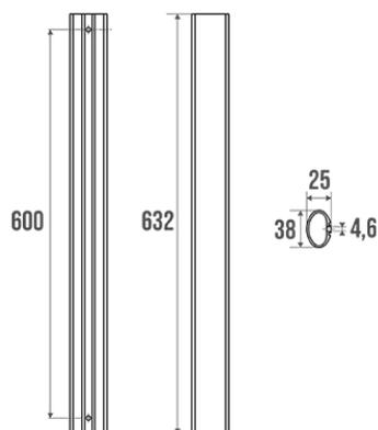
Tube elliptique 38 x 25 mm en aluminium époxy.
