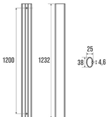
Tube elliptique 38 x 25 mm en aluminium époxy.
