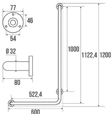
Tube inox 304 poli brillant Ø 32 mm. 3 points de fixation. Coude à droite.
