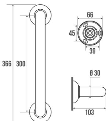
Tube aluminium jaune Ø 30 mm, platines en résine de synthèse et cache-fixations jaune (RAL 1023) en résine de synthèse, Ø 66 mm.
