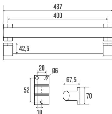
Tube aluminium bleu Ø 30 mm, platines en résine de synthèse et cache-fixations bleu (RAL 5002) en résine de synthèse, Ø 66 mm.
