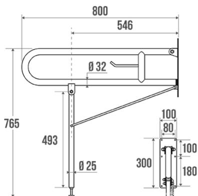
Tube inox 304 poli brillant Ø 32 mm. Platine en inox poli brillant.
