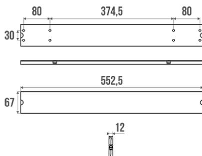
Rail de fixation équipé d'un cache en aluminium anodisé, livré avec 2 verrous en résine couleur anthracite. Le cache peut être remplacé par une barre d'appui droite 552 mm ou un dossier + 1 accoudoir ou un dossier + 1 barre relevable pour siège de douche et permet ainsi de transformer sa douche "classique" en douche "ergonomique et confortable".
