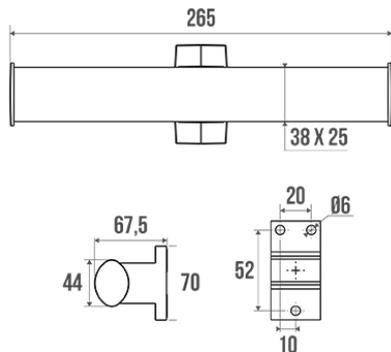
Tube elliptique en aluminium anodisé 38 x 25 mm. Cache-fixations en résine de synthèse chromés.
