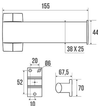
Tube elliptique en aluminium anodisé 38 x 25 mm. Cache-fixations en résine de synthèse chromés.
