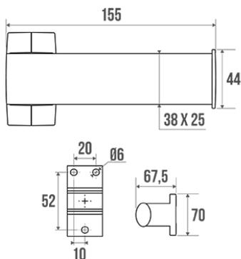
Tube elliptique en aluminium anodisé 38 x 25 mm. Cache-fixations en résine de synthèse chromés.
