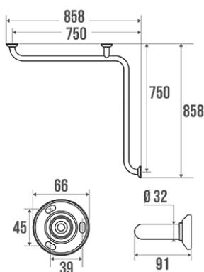
Tube laiton nickelé chromé Ø 32 mm. Angle 90°. Platines et cache-fixations en résine de synthèse chromé brillant. 3 points de fixations invisibles.
