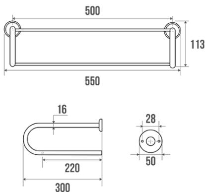
Tube laiton nickelé et acier chromé.
